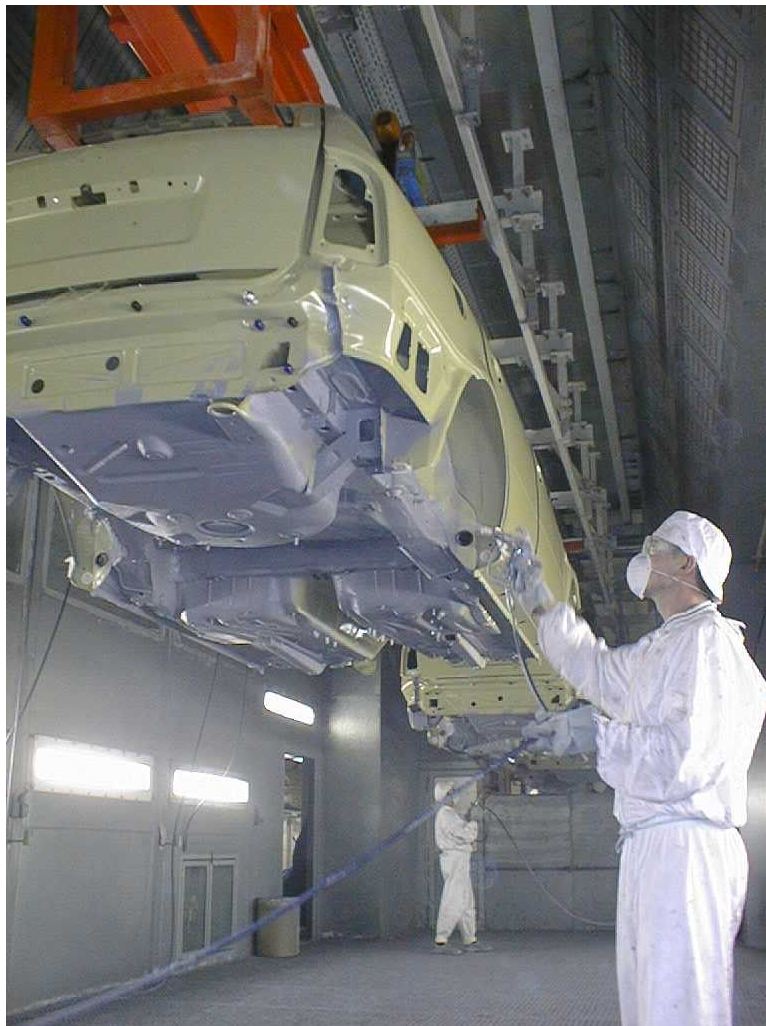
Obrázek č. 1: Nanášení ochranné vrstvy PVC plastisolu [1].
