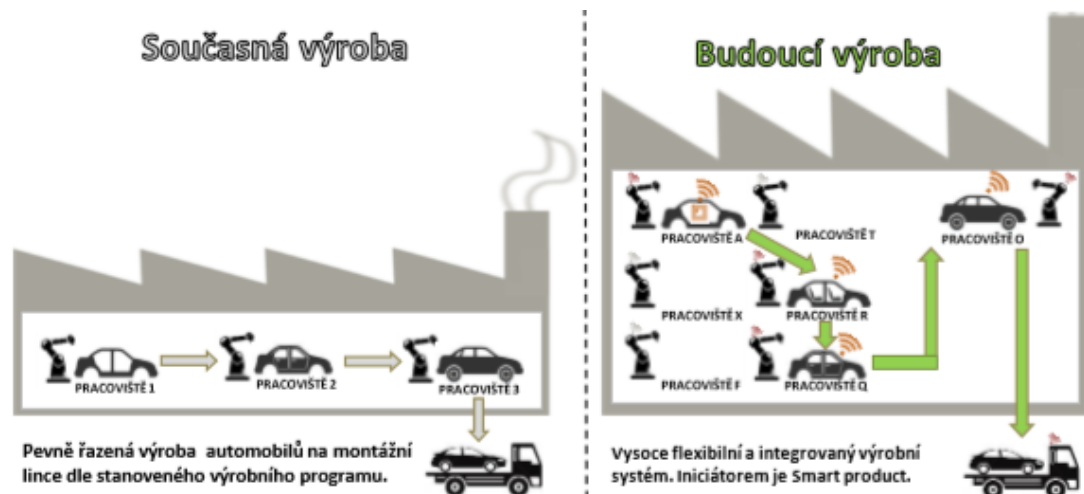
Obrázek 2 Porovnání současné a budoucí výroby ve Smart Factory (Balga, ©2018)
