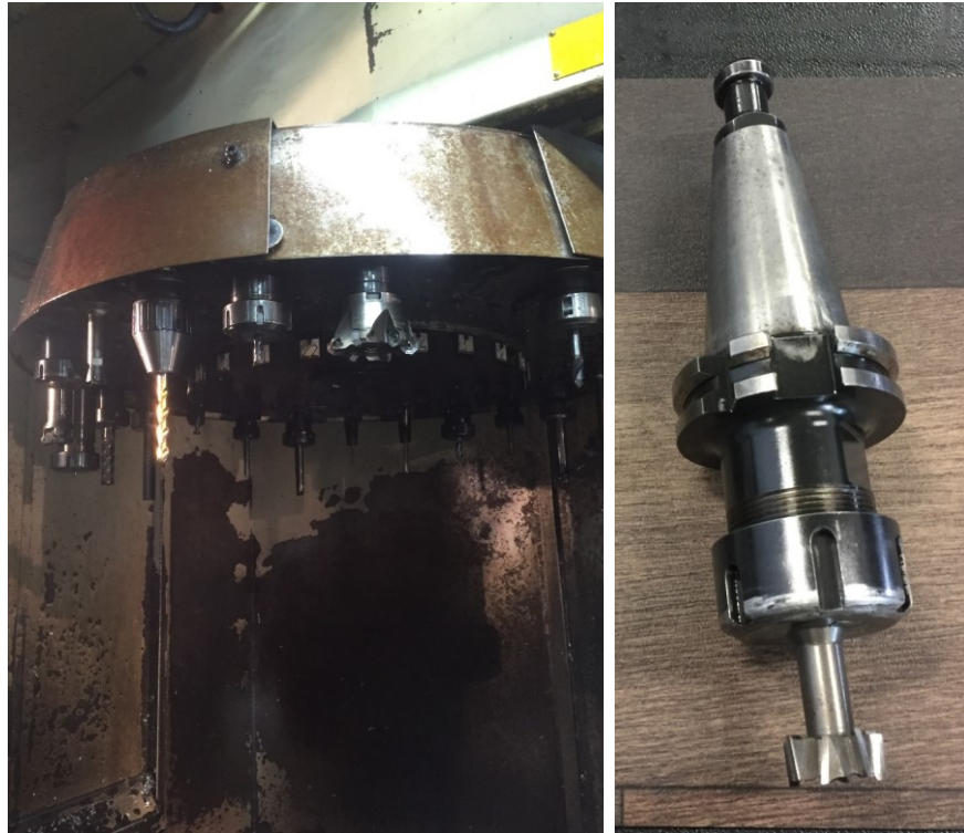
Obrázek 31 Zásobník nástrojů a nástrojový držák s upínacím čepem (Vlastní zpracování)
