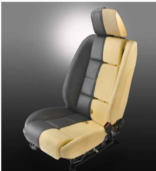
Obr. 18: Automobilové sedadlo z PUR pěny [37]
