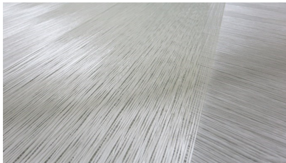
Obr. 9: Skelná vlákna (E-sklo) [23]
