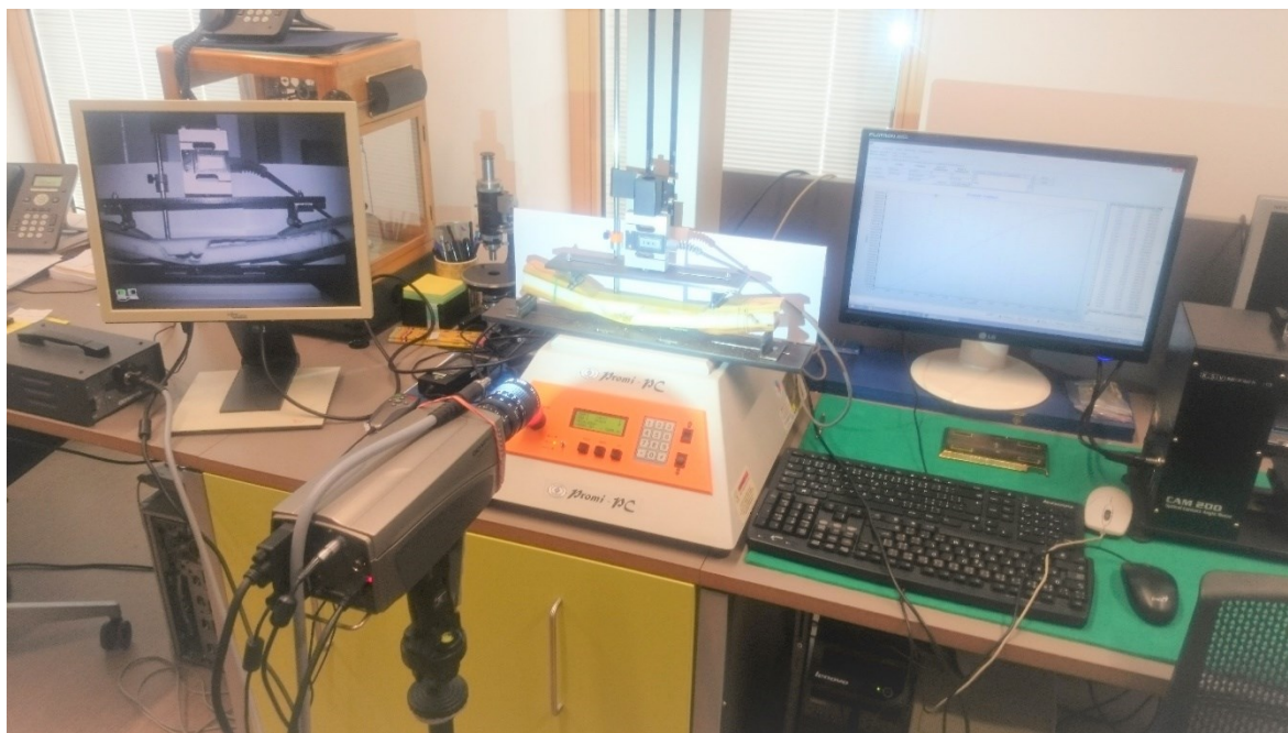
Obr. 54: Pracoviště pro čtyřbodovou ohybovou zkoušku
