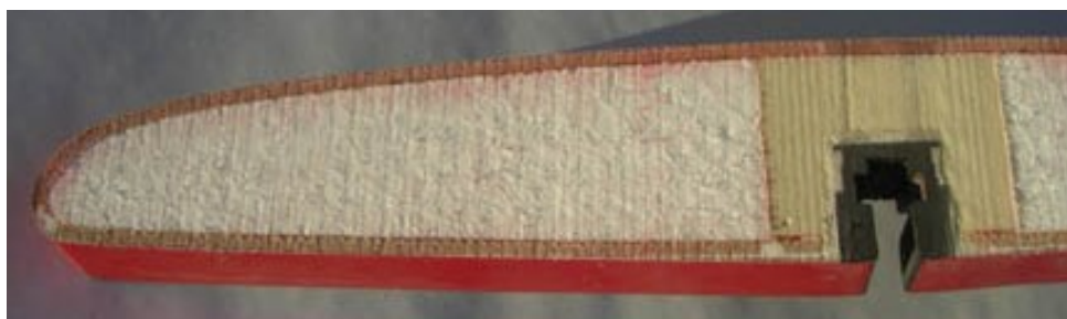
Obr. 17: Řez surfovacím prknem s jádrem z expandovaného polystyrenu [36]
