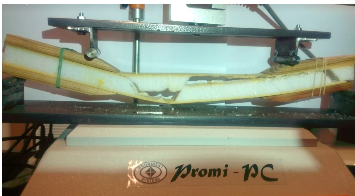
Obr. 60: Výsledné porušení vzorku V3 – 1 čtyřbodovou ohybovou zkouškou
