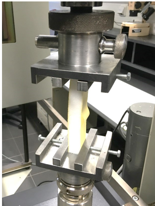
Obr. 41: Použitý přípravek pro měření tlakové zkoušky
