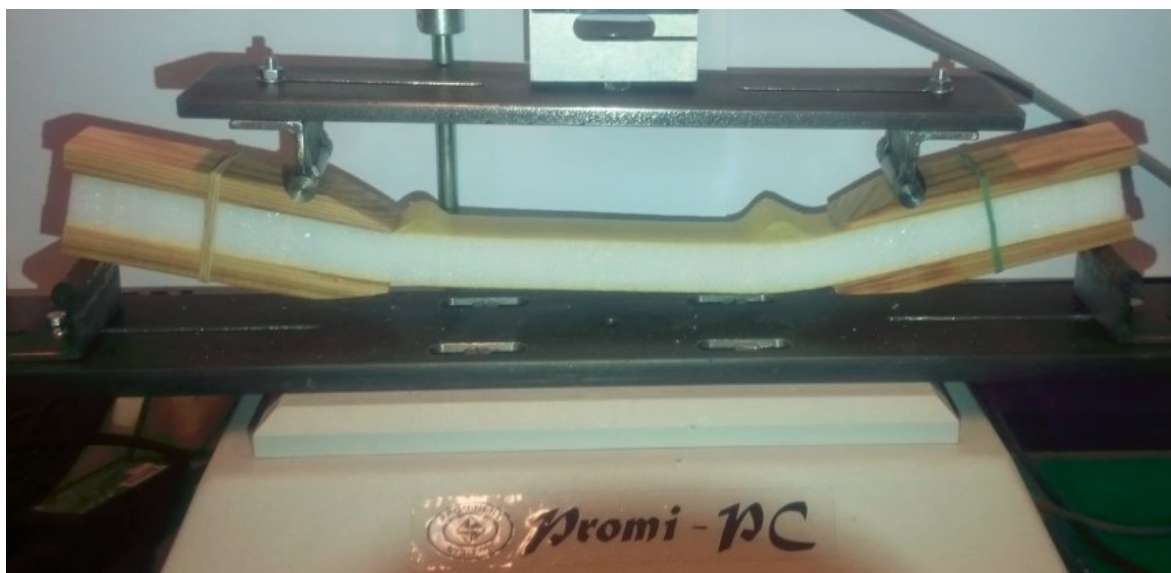
Obr. 59: Výsledné porušení vzorku V1 – 1 čtyřbodovou ohybovou zkouškou
