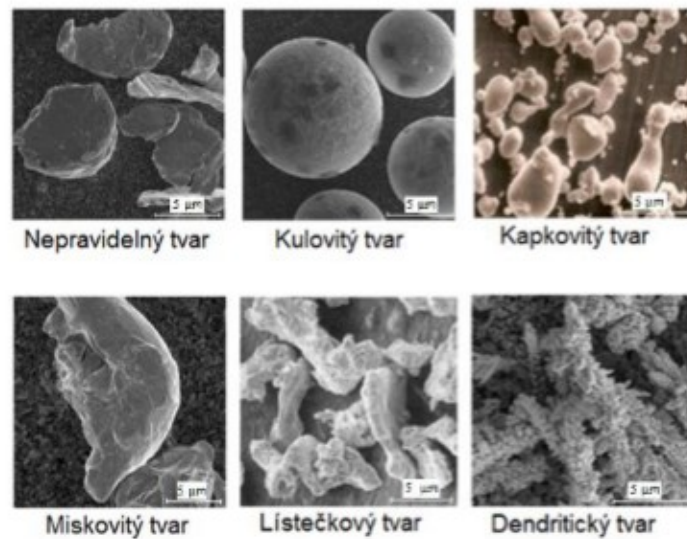
Obr. 15: Geometrický tvar zrn
