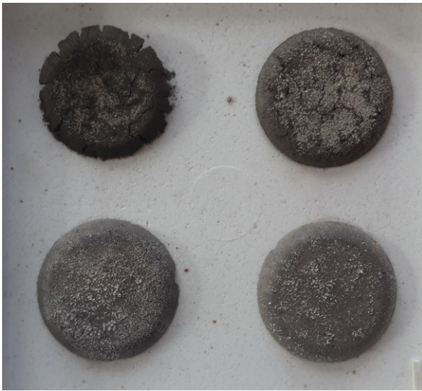
Obr. 48: Vzorky po odstranění části pojiva a SH (250+)
