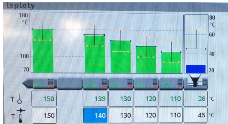
Obr. 44: Teploty pásem plastikační jednotky (šneku)
