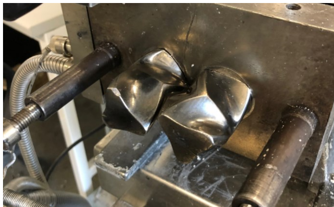
Obr. 26: Hnětič Brabender Plastograph: 1) hnětič, 2) komora, 3) hnětidla
