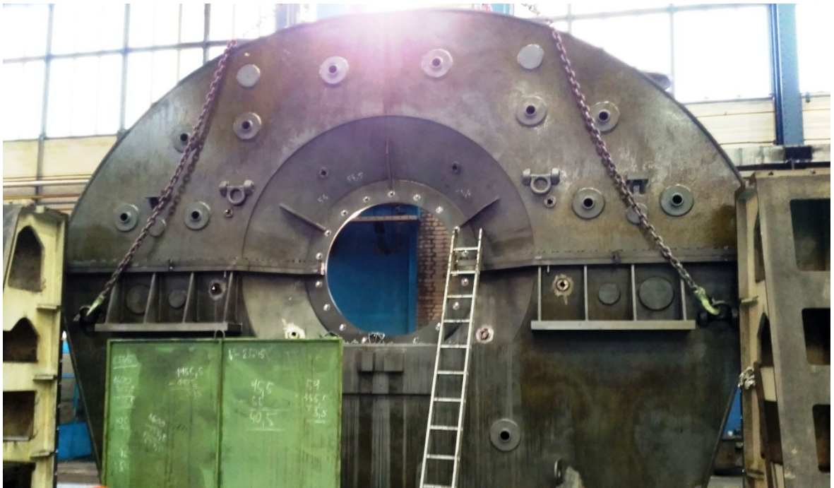
Obr. 42. Horní díl a spodní díl radiálního výstupního hrdla při opracování
