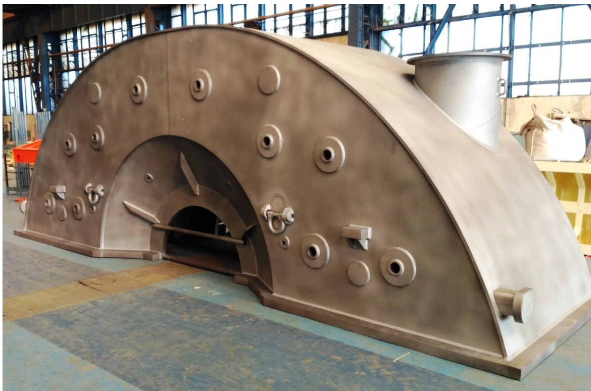
Obr. 38. Svařenec horního dílu radiálního výstupního hrdla
