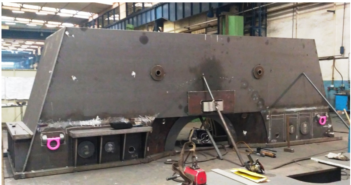
Obr. 35. Rozpracovaný spodní díl radiálního výstupního hrdla – přední strana
