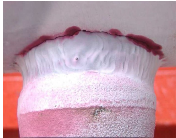
Obr. 24. Penetrační (kapilární) zkouška [19]
