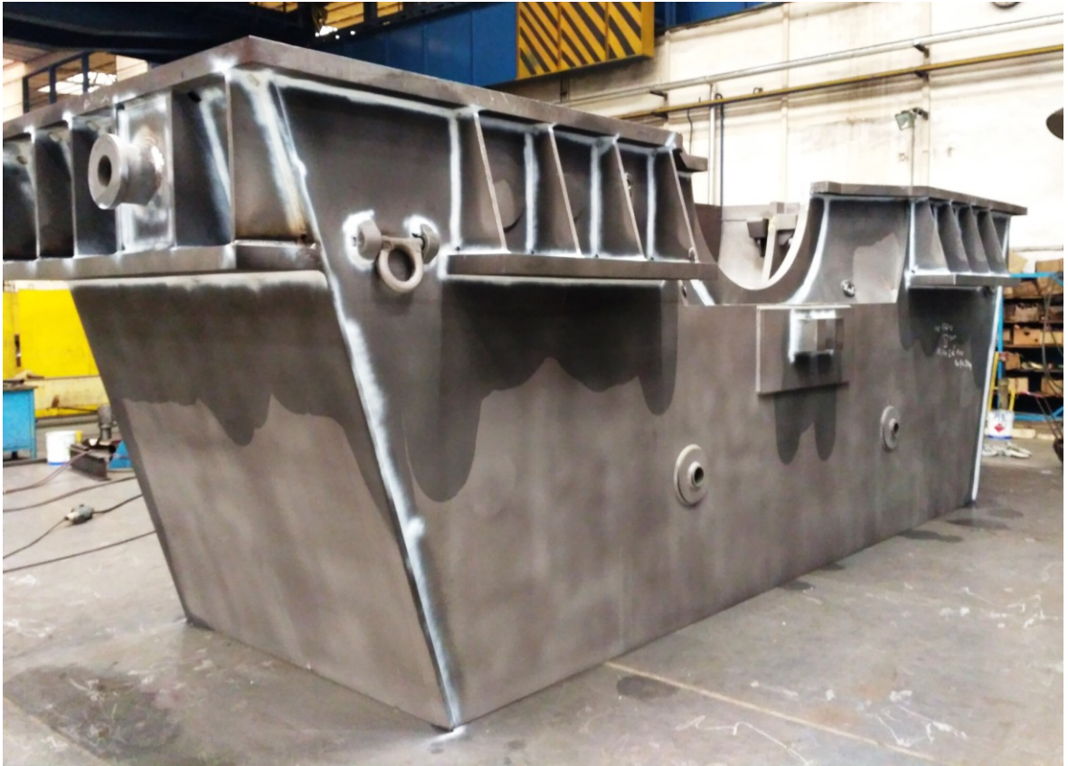
Obr. 36. Spodní díl radiálního výstupního hrdla po magnetické zkoušce
