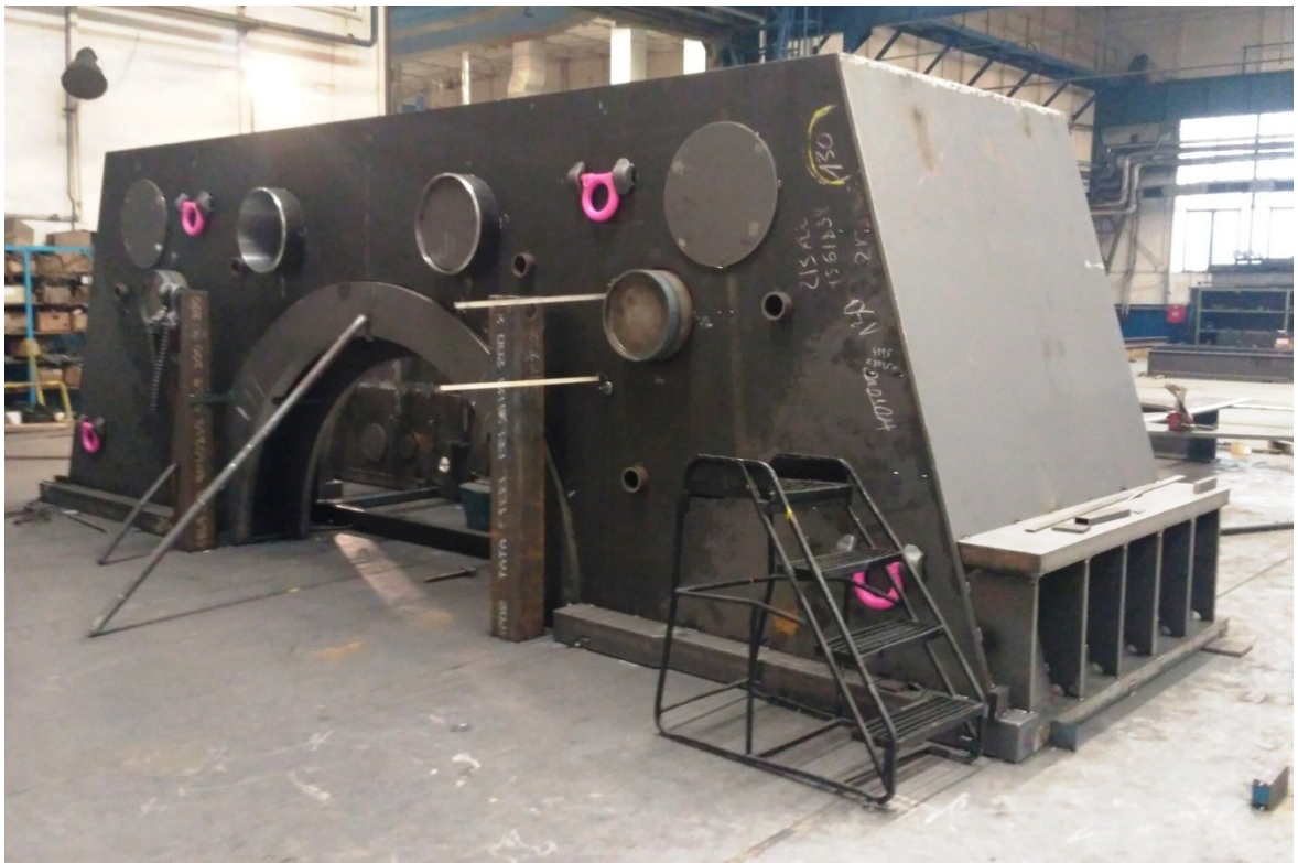
Obr. 34. Rozpracovaný spodní díl radiálního výstupního hrdla - zadní strana
