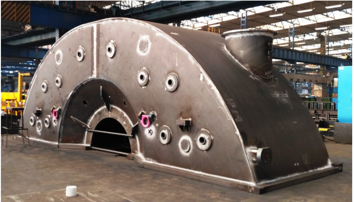
Obr. 39. Horní díl radiálního výstupního hrdla po magnetické zkoušce
