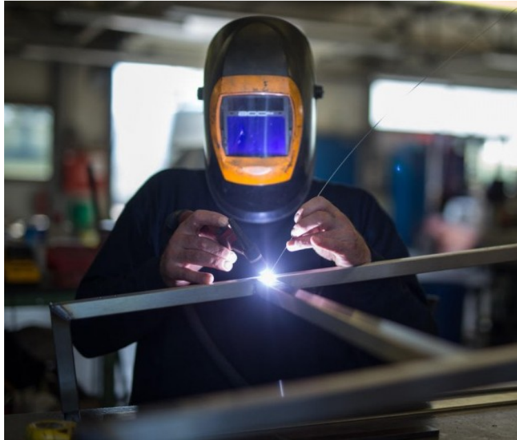
Obr. 13. Ukázka ručního obloukového svařování [17]
