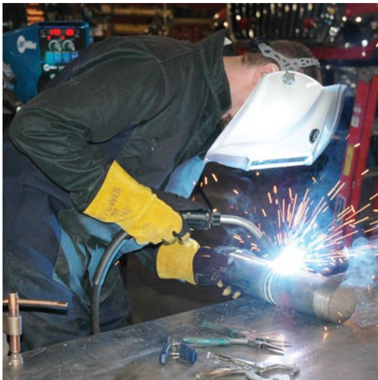
Obr. 14. Ukázka poloautomatického obloukového svařování [17]
