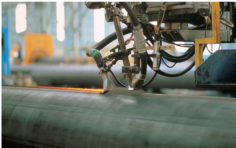
Obr. 16. Ukázka automatického obloukového svařování [17]
