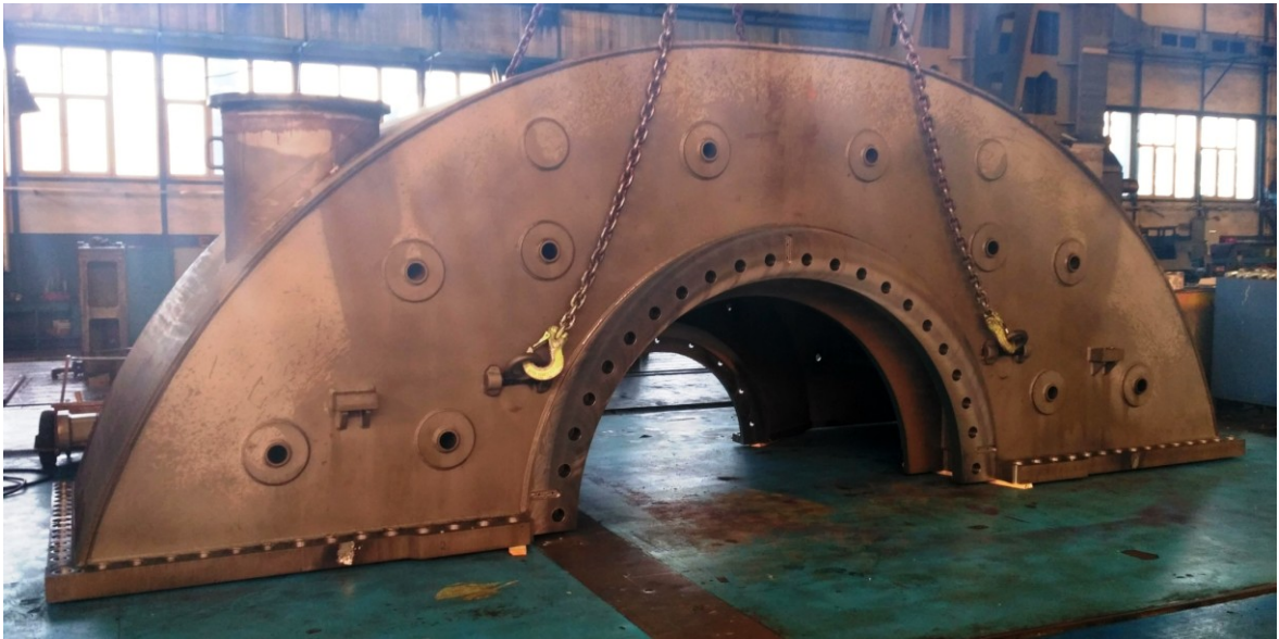
Obr. 41. Horní díl radiálního výstupního hrdla po opracování
