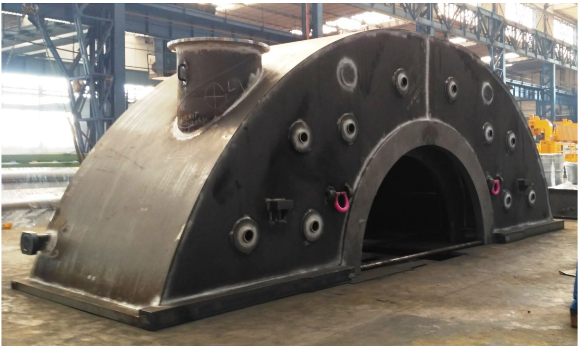
Obr. 40. Horní díl radiálního výstupního hrdla po magnetické zkoušce
