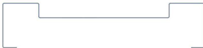
Obr. 46 Tvar ohýbaného profilu nájezdu
