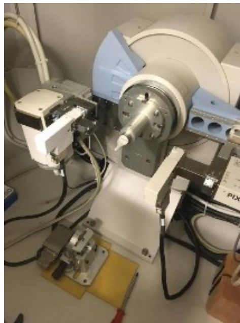
Obr. 23 uchycení vzorku v čelistech rentgenu
