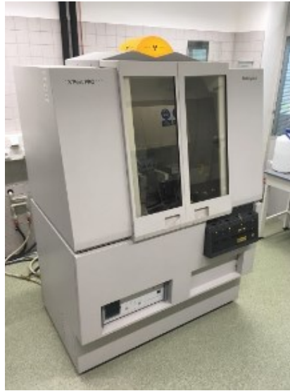
Obr. 22 rentgen na měření mikrostruktury
