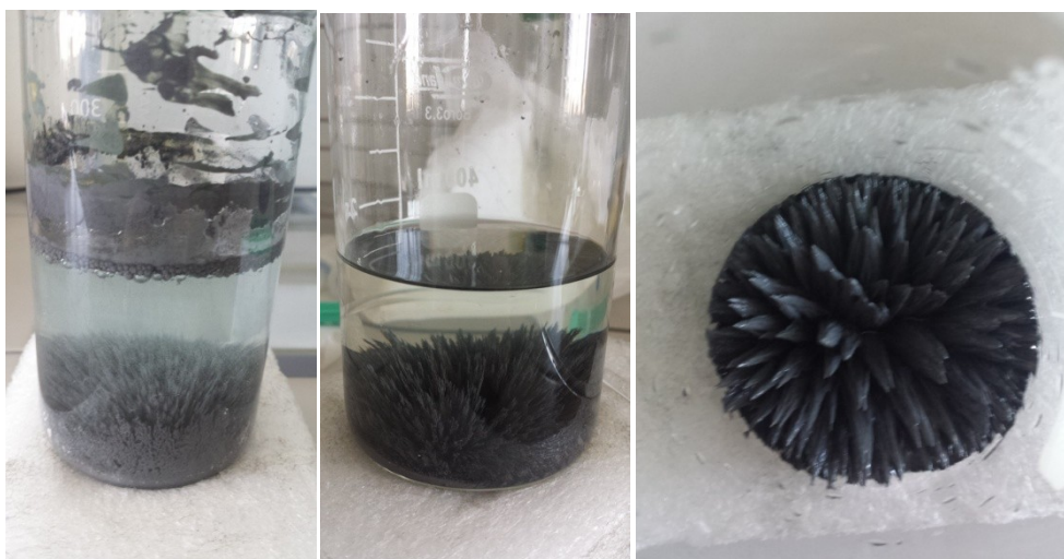
Obrázek 20: Ukázka dekantační metody (zachycení částic CI na dně kádinky pomocí magnetu).
