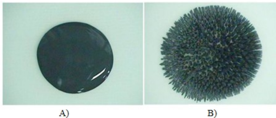
Obrázek 1: (A) neaktivovaná MR kapalina; (B) tatáž kapalina v magnetickém poli [3].
