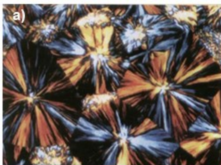
Obrázek 6: Sférolity polypropylenu v polarizovaném světle [17]
