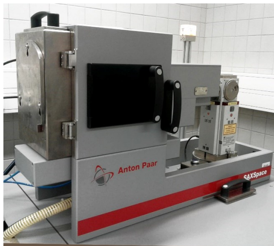
Obrázek 31: Přístroj SAXS Anton Paar SAXSpace (jeho část)
