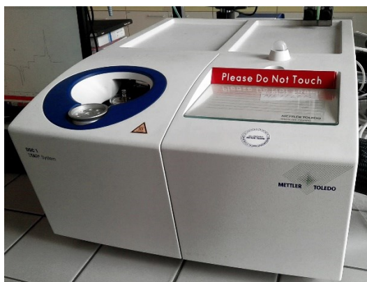
Obrázek 29: DSC přístroj Mettler Toledo STAR e System
