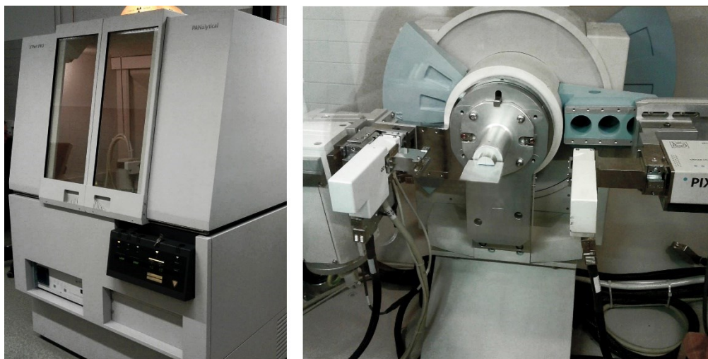
Obrázek 30: WAXS přístroj PANalytical X'Pert PRO a detail držáku se vzorkem
