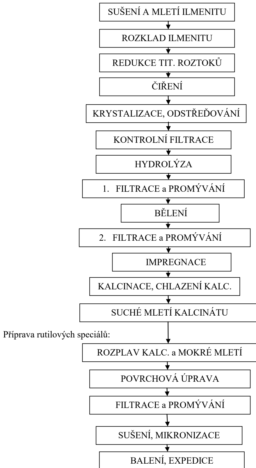
Obr. 10: Blokové schéma výroby titanové běloby [10]
