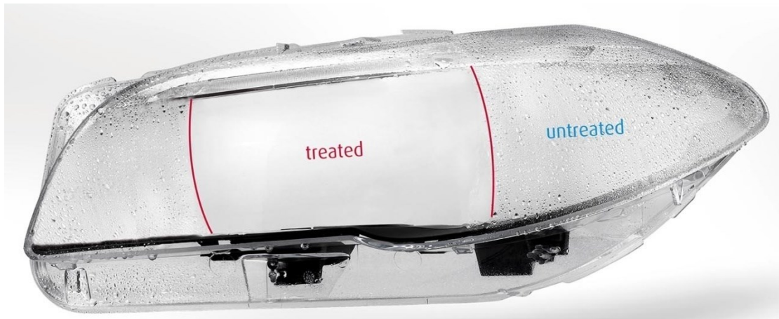
Obr. 28 Účinek ošetření polykarbonátu PC kombinací plazmy a externí protizamlžující vrstvy u automobilových světlometů. [46]
