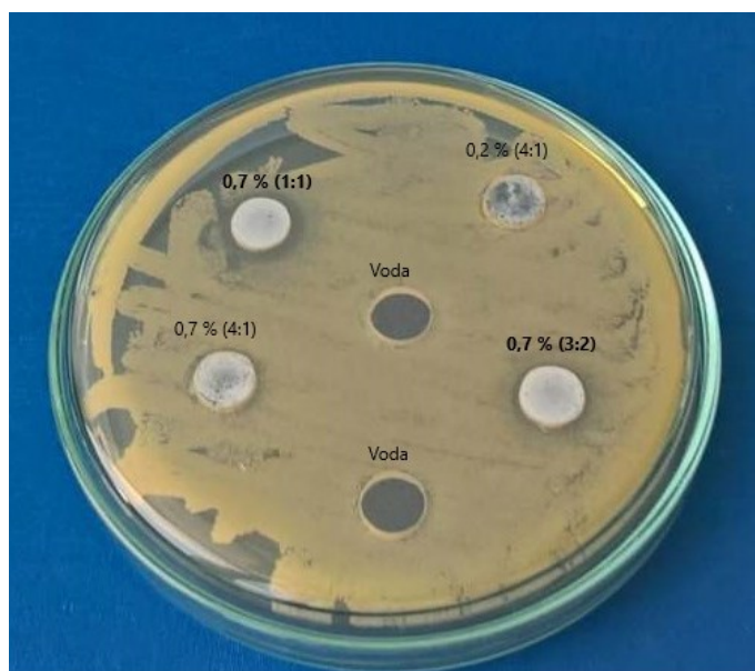
Obr. 47. Difúzní jamková metoda s roztěrem – vliv emulzí s 0,7 % stabilizátoru s poměrem cCNC:ZnO 1:1, 3:2, 4:1 a emulze s 0,2 % stabilizátoru
