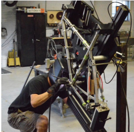
Obr. 9: Stolice na uchycení trubek pro svařování rámu [49]
