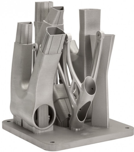
Obr. 13: Díly rámu z 3D tisku [40]
