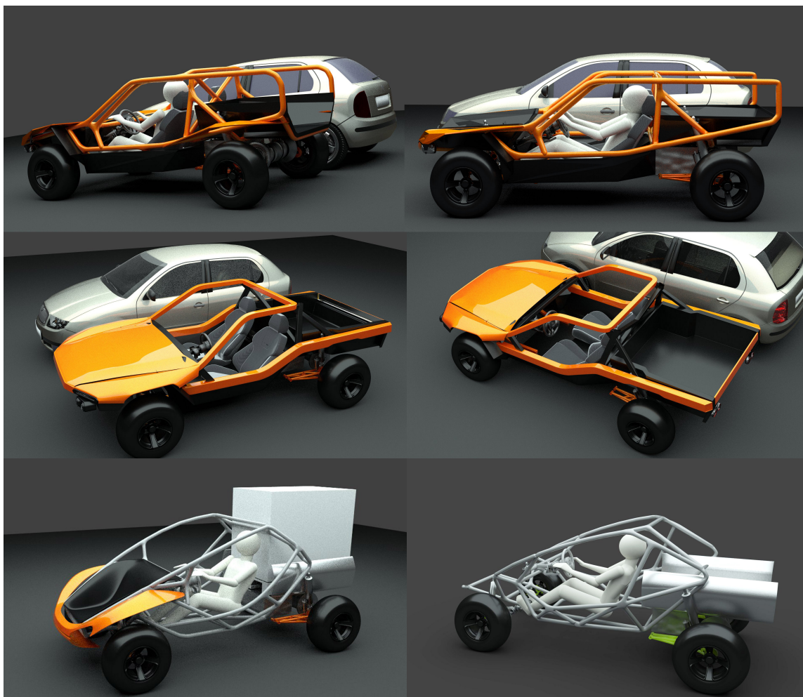
Obr. 37. Základní 3D modely nosných rámců Buggy
