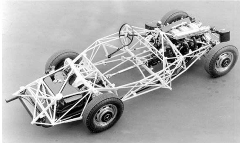
Obr. 25. Příhradový rám závodního vozů Mercedes W196 [31]
