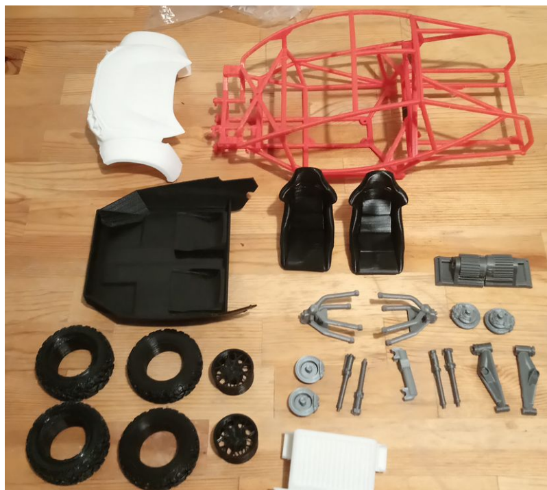
Obr. 51. Model – 3D tisky jednotlivých dílů
