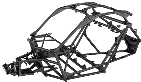
Obr. 22. Nosný rám Can-Am Maverick X3 [26]
