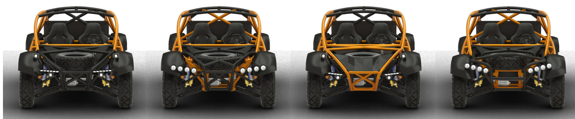
Obr. 50. Různá řešení přední části vozu pro chystaný model
