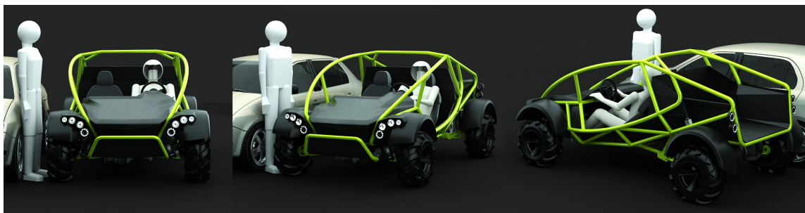
Obr. 39. Hledání nejvhodnějšího řešení rámu
