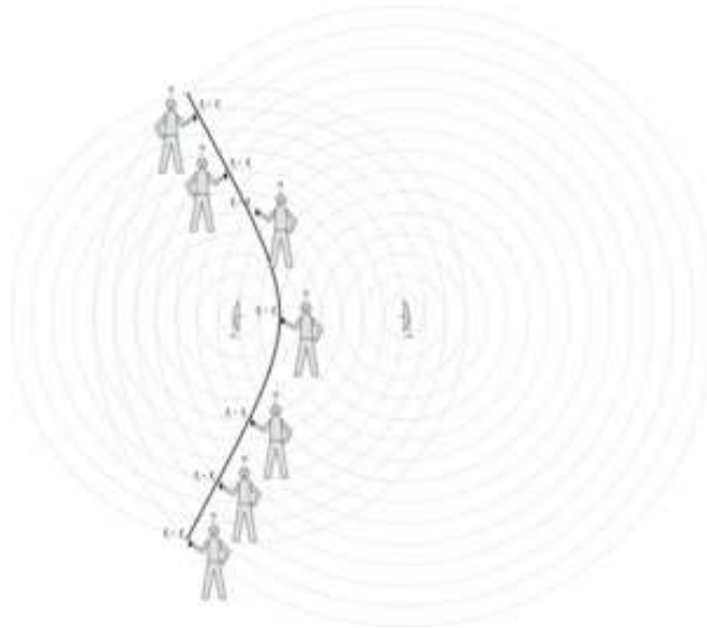
Obr. 2. Přijetí signálu ze dvou vysílačů lze stanovit hyperbolu, na které se nachází přijímač; přesnou pozici však určit nelze
