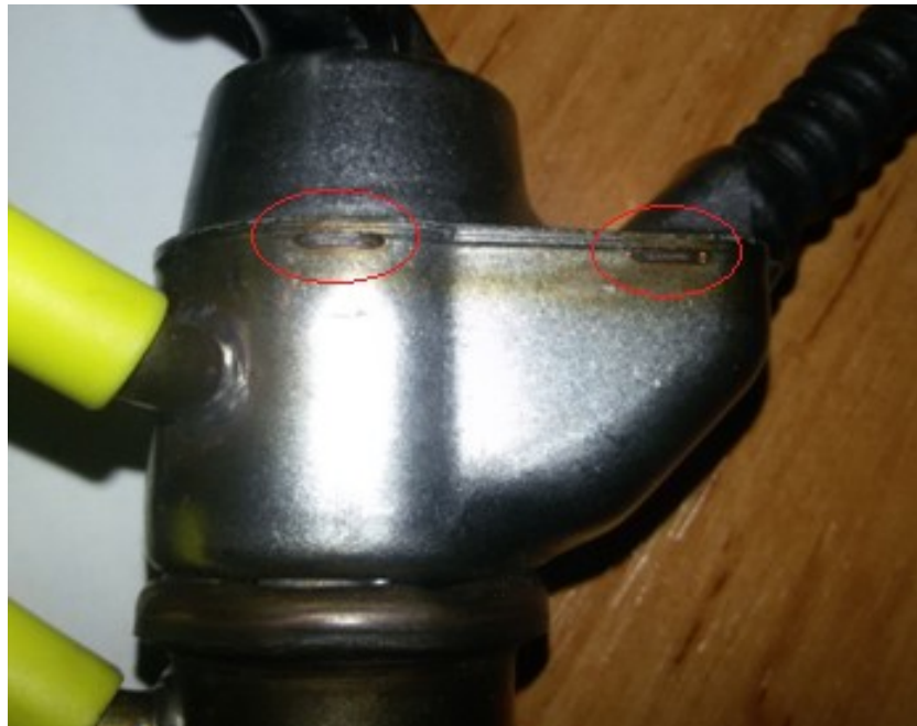
Obr. 83. Detail provedeního svaru na vstřikovači
