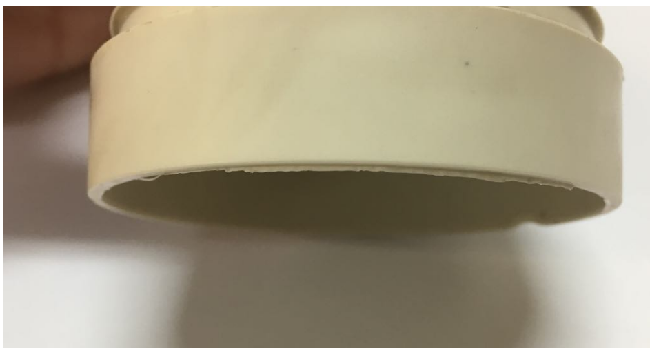
Obr. 13: Přetok v dělicí hraně na výrobku
