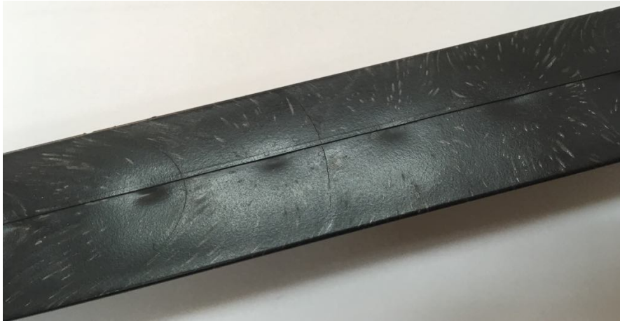
Obr. 14: Propadliny na výstřiku vlivem žeber
