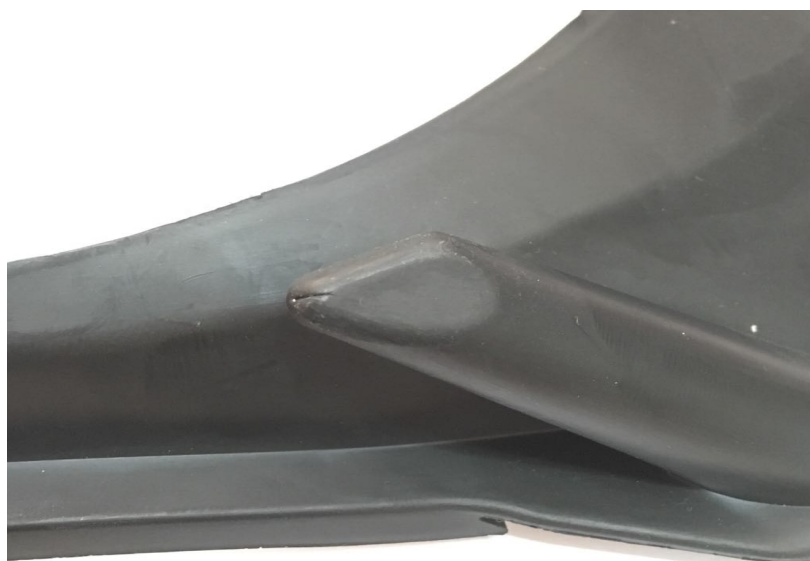
Obr. 15: Viditelný studený spoj na výstřiku
