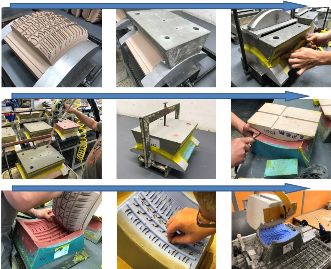
Obrázek 11 Výroba flexibilové formy – postup činností [zdroj: vlastní]
