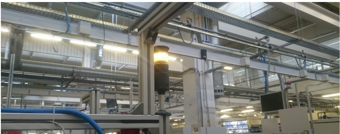
Obr. 22. Signalizačný Andon (vlastné spracovanie)
