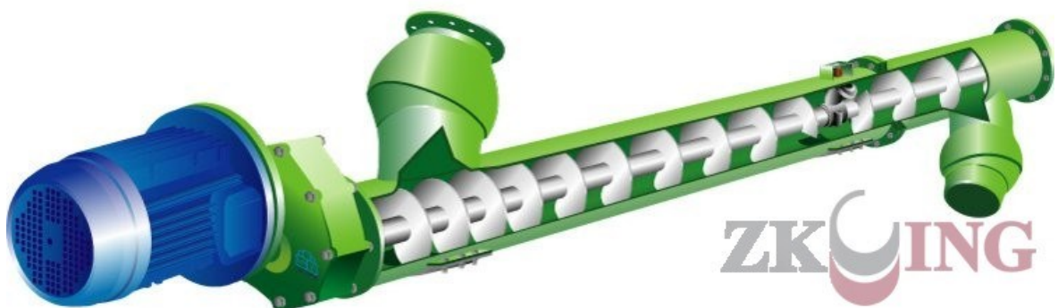
Obr. 22. Trubkový šnekový dopravník v řezu [3]
