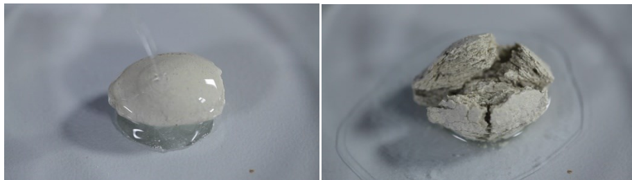
Obr. 44. Průběh rozpadu pelety po přidání vody [15]
