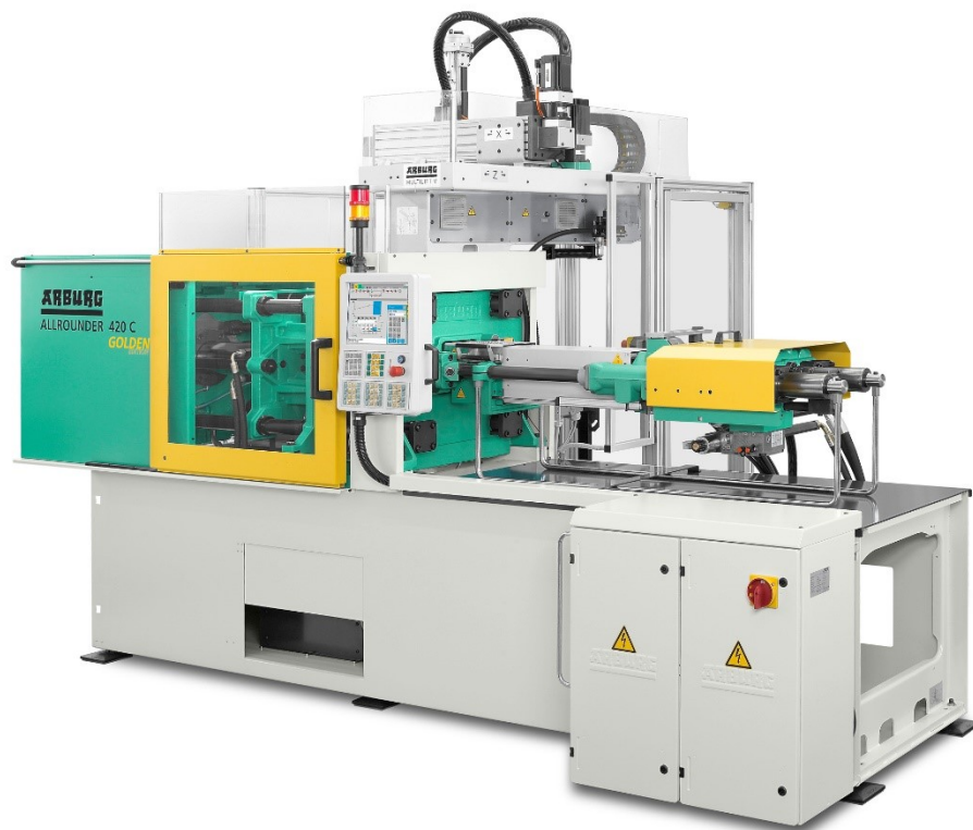
Obr. 11. Vstřikovací stroj Arburg Allrounder 420 C Golden Edition
