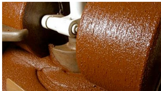
Obr. 11 Válcování čokoládové hmoty [22]
