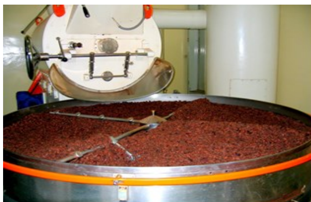
Obr. 7 Pražení kakaových bobů v pražárně [23]
