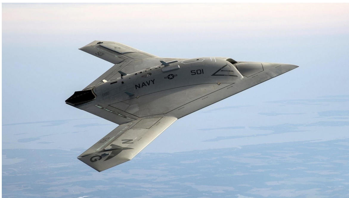
Obr. č. 10: X-47B – neviditelný bezpilotní letoun
