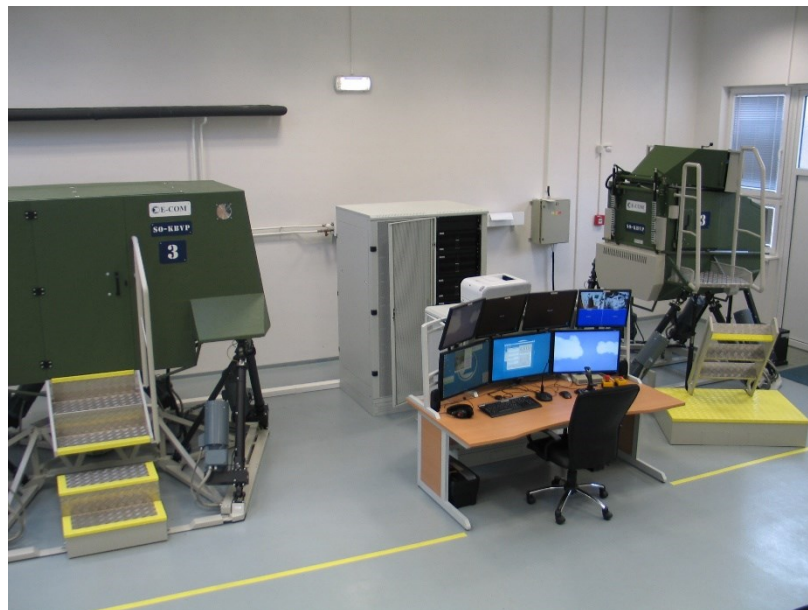
Obr. 4: Pohled do haly s instalovaným simulátorem VS-I pro kolové bojové vozidlo pěchoty PANDUR II. Vlevo pracoviště velitele a střelce-operátora, uprostřed pracoviště instruktora, vpravo-maketa pracoviště řidiče. [2]
