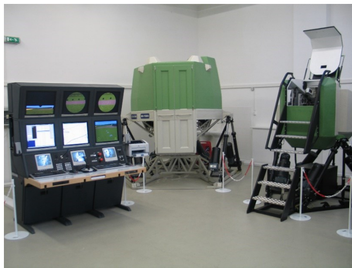
Obr. 2: Pohled do haly s instalovaným simulátorem VS-I pro tank T-72M4Cz. Vlevo pracoviště instruktora, uprostřed maketa pracoviště velitele a střelce-operátora, vpravo-maketa pracoviště řidiče. [2]
