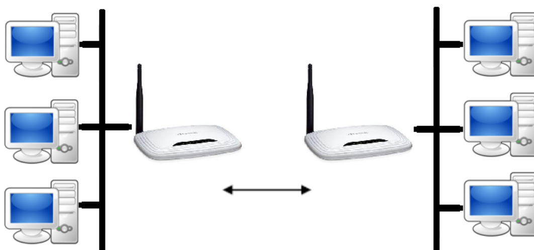
Obrázek 3. Schéma principu mostu
