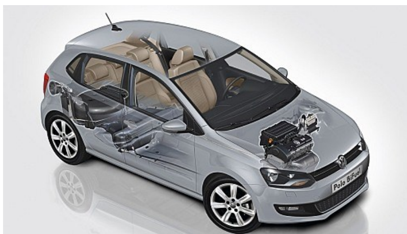
Obrázek 2: Automobil Volkswagen Polo obohacen o pohon LPG [13]
