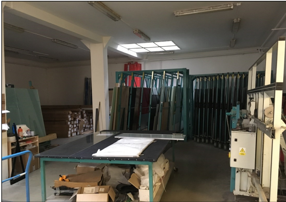
Obr. 19. Pracoviště sklenáře – stojany a řezací stůl (vlastní fotografie).
