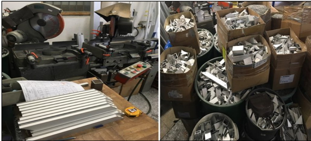
Obr. 16. Pracoviště pro řezání profilů (vlevo) a uložení hliníkového odpadu (vlastní fotografie).
