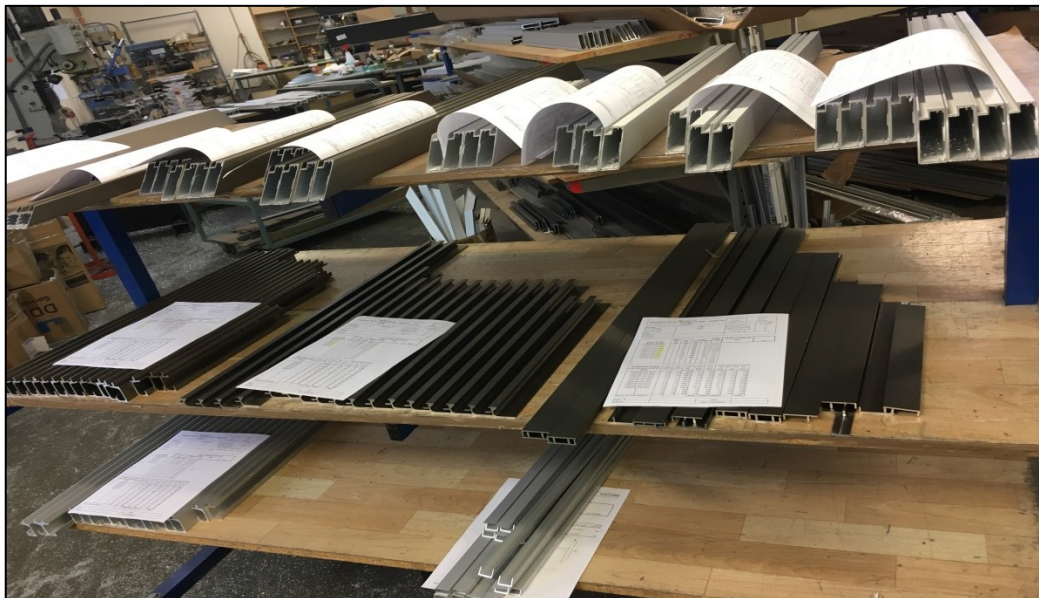
Obr. 17. Stojan se skupinami nářezaných profilů a výrobními listy (vlastní fotografie).
