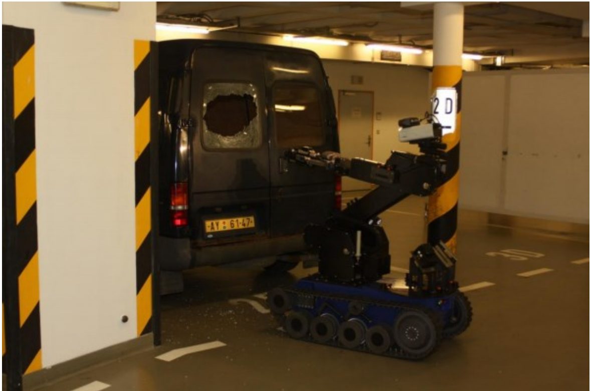
Obr. 11 – Pyrotechnický robot po rozstřelení zadního okna. [30]
