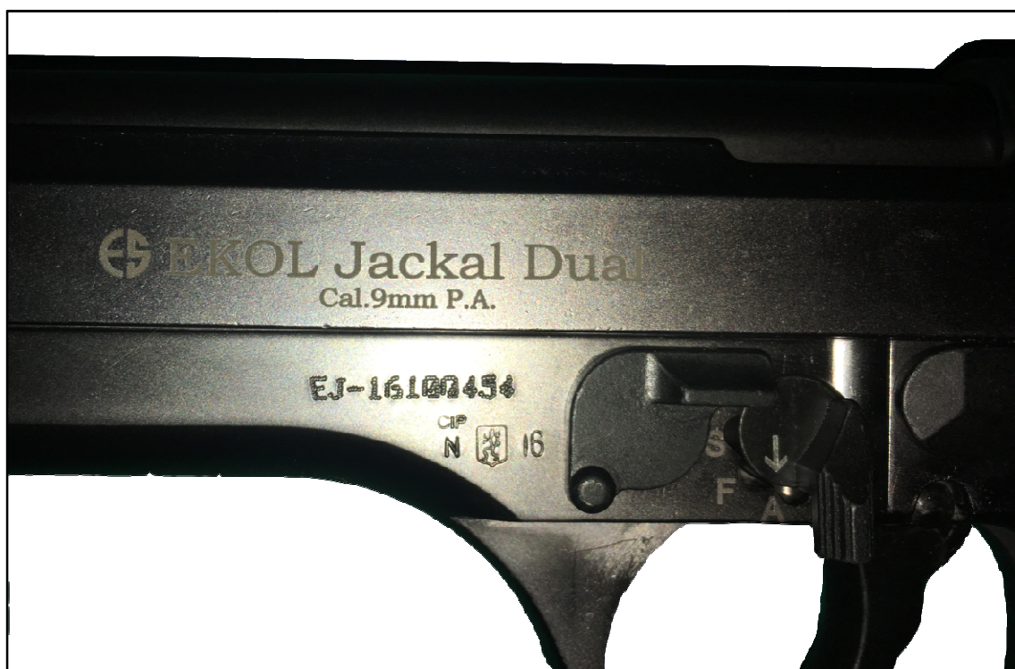
Obr. 47. Detail režimu přepínače střelby u expanzní pistole EKOL Jackal Dual 9 mm
