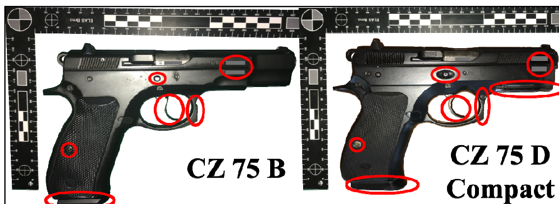
Obr. 16. Rozdíly pistolí CZ 75 B a CZ 75 D Compact [vlastní]
