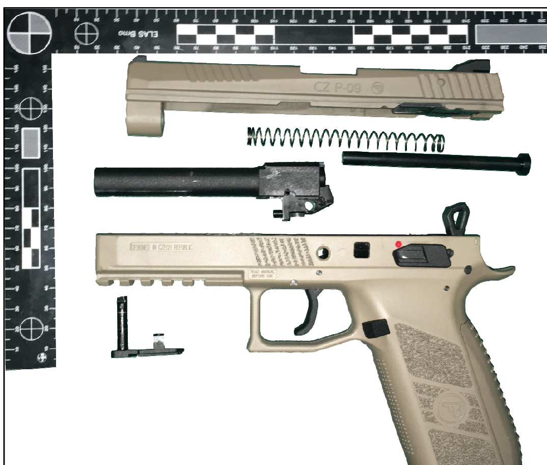
Obr. 8. Uživatelsky rozebraná airsoftová pistole CZ P-09 [vlastní]
