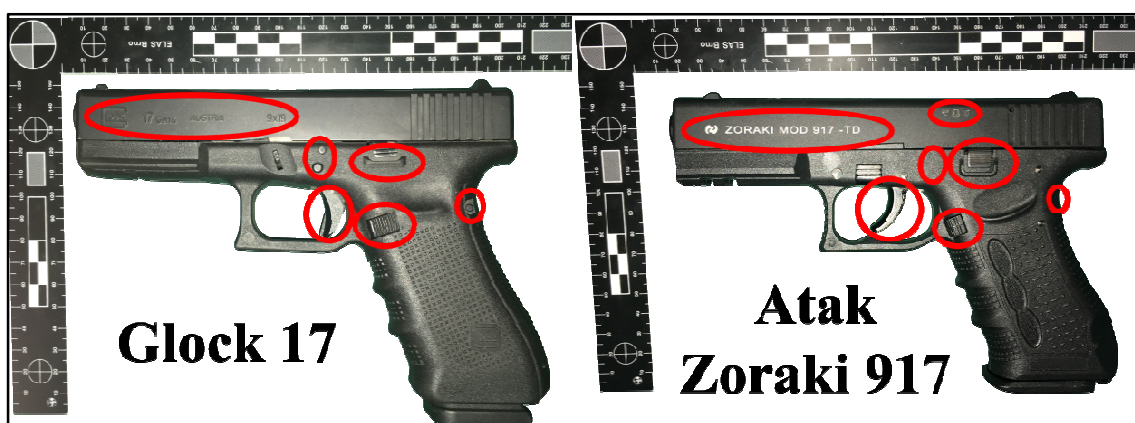
Obr. 36. Další rozdíly pistolí Glock 17 a Atak Zoraki 917 [vlastní]
