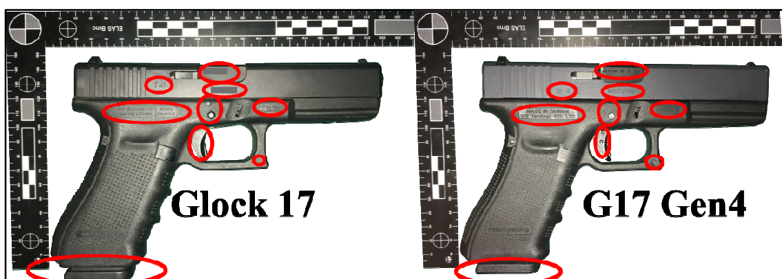
Obr. 34. Rozdíly pistolí Glock 17 a G17 Gen 4 [vlastní]
