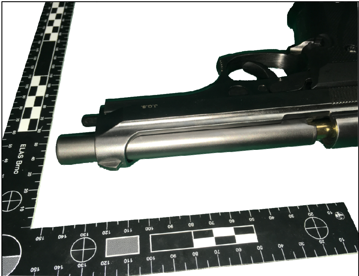
Obr. 5. Pokus dostat náboj do expanzní zbraně skrze výhozné okénko a uzavření závěru [vlastní]
