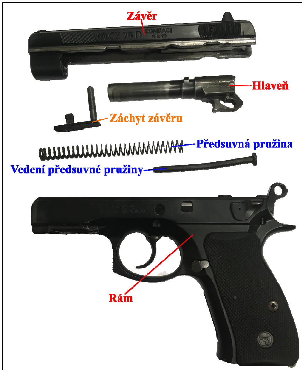
Obr. 3. Uživatelsky rozebraná CZ 75 D Compact [vlastní]
