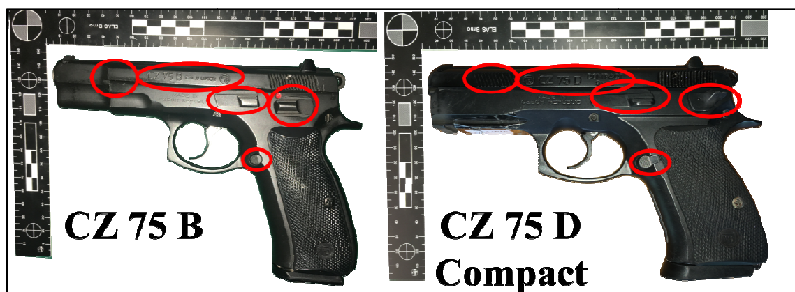
Obr. 18. Rozdíly levé strany pistolí CZ 75 B a CZ 75 D Compact [vlastní]
