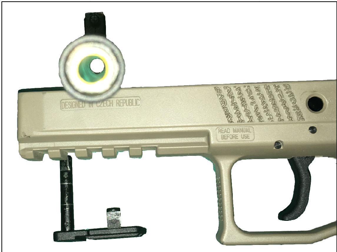
Obr. 9. Detail hlavně a záchyty závěru airsoftové pistole CZ P-09 [vlastní]
