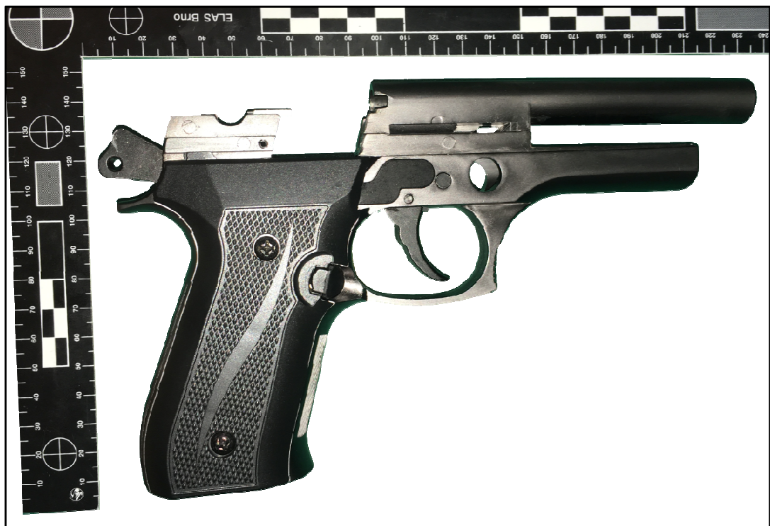
Obr. 6. Rozebraná expanzní zbraň Ekol Jackal Dual 9 mm [vlastní]
