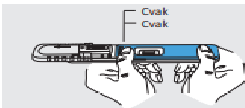
Obrázek 15 Čtvrtým krokem – zacvaknutí sběrače do kazety. [61]
