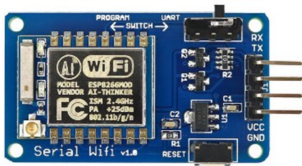
Obr. 9. Ukázka WiFi modulu ESP-07 ESP8266 [13]
