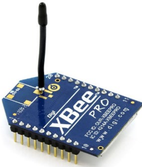
Obr. 3. Ukázka ZigBee modulu XBCAWIT-001 [6]
