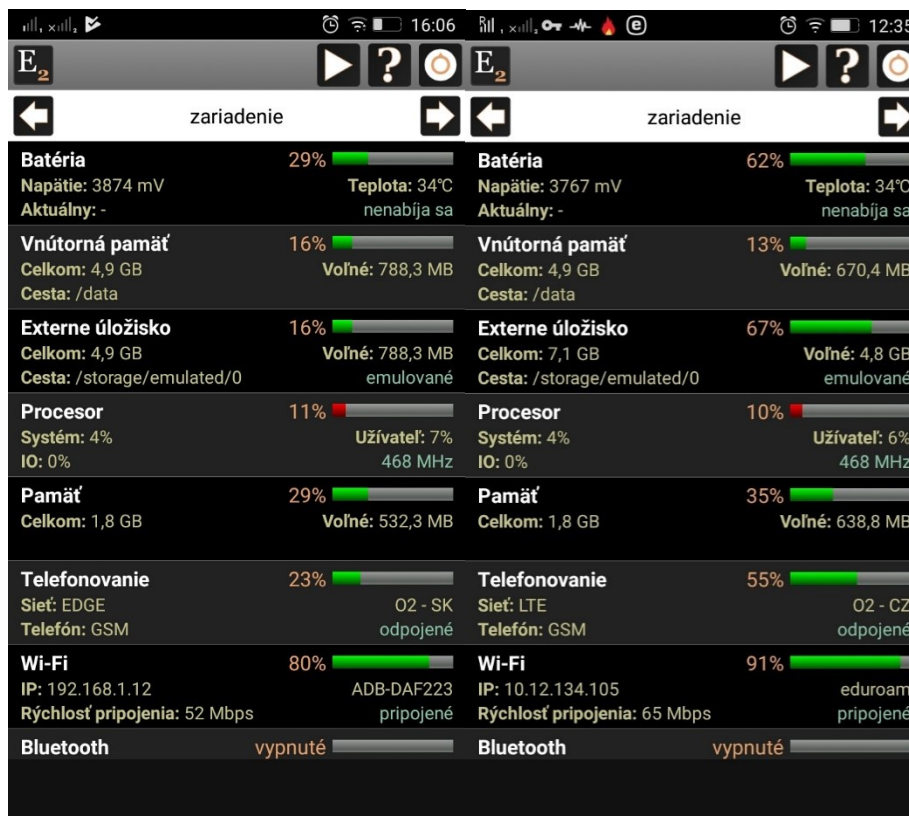
Obrázok 17 Test výkonu zariadenia pomocou aplikácie Elixir 2 na ľavej strane bez a na pravej strane s nainštalovanými aplikáciami
