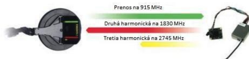
Obr. 12. Princíp detektoru nelinearít [25] , upravil Hollý 2018
