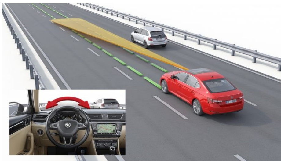
Obr. 11: Snímání systémem Lane Assist [19]
