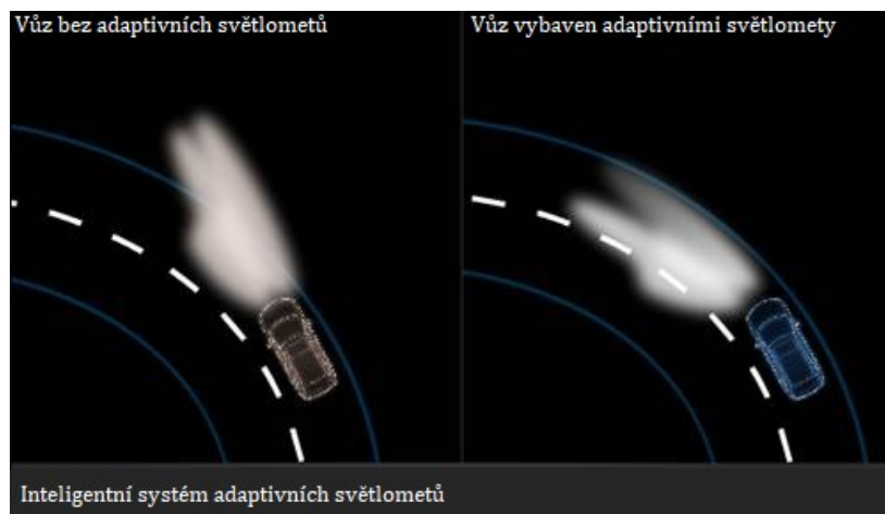
Obr. 13: Rozdíl světelného kužele světlometů, převzato z [20]
