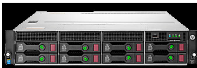
Obr. 34 Datové úložiště kamerového systému UTB [23]
