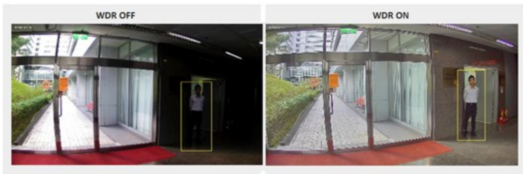
Obr. 13 Příklad kompenzace protisvětla WDR [21]
