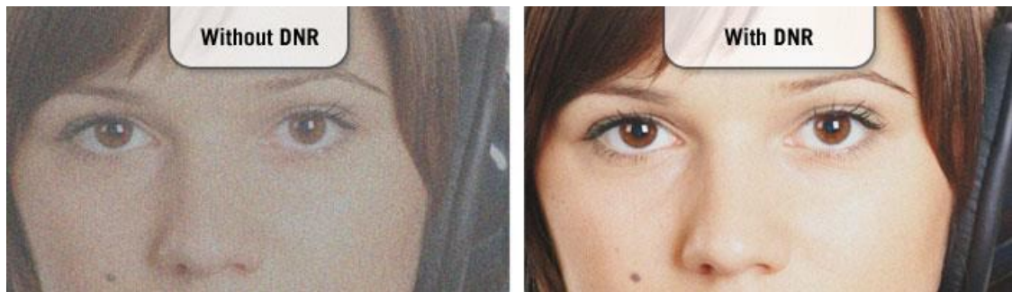
Obr. 12 Příklad redukce šumu DNR [19]
