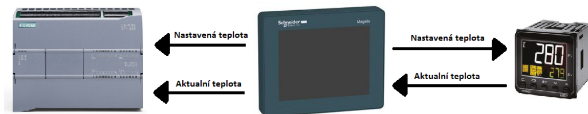
Obr. 25 – Funkce propojení regulátoru teploty s PLC přes HMI.
