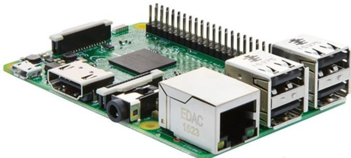
Obr. 8. Kompletní minipočítač Raspberry 3 Model B [13].
