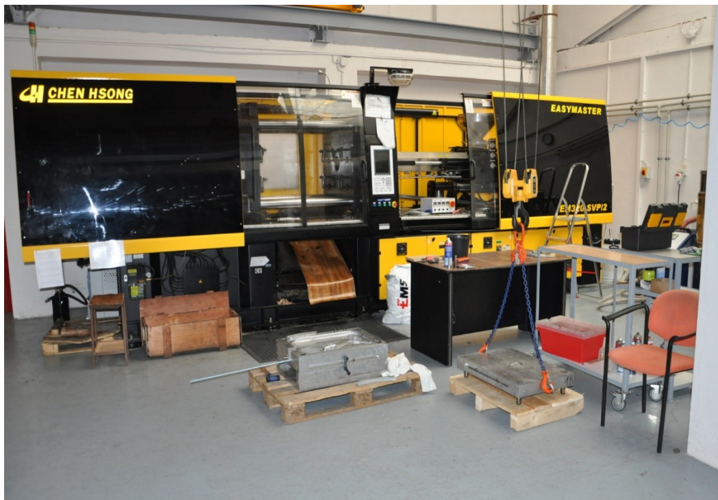
Obr. 3 Vstřikovací zařízení Chen Hsong Easymaster 150-SVP/2
