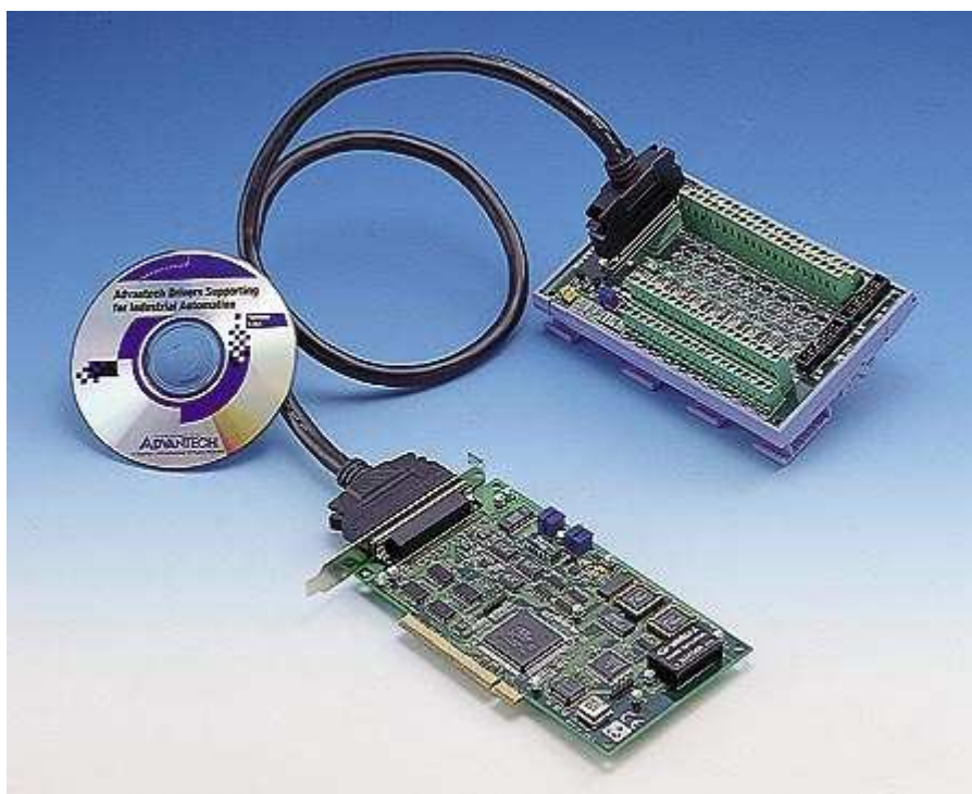
Obr. 17 Karta PCI 1711 s komponenty
