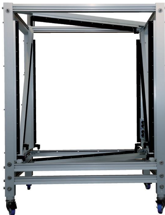
Obr. D1. Balistický měřicí systém Kistler Typ 2 [21]
