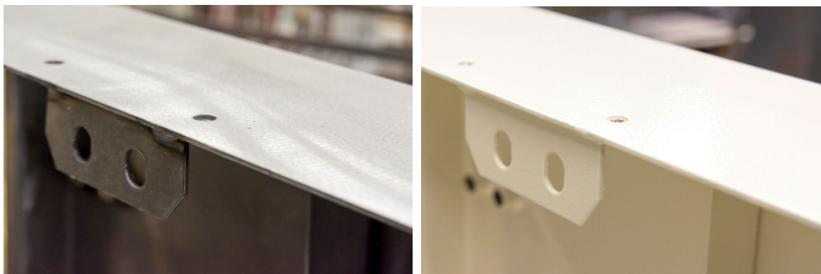
Obr. 59. Surový díl vs. lakovaný díl (barevný odstín RAL9010)
