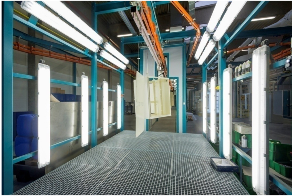
Obr. 44. Část prostoru lakovny – kontrola
