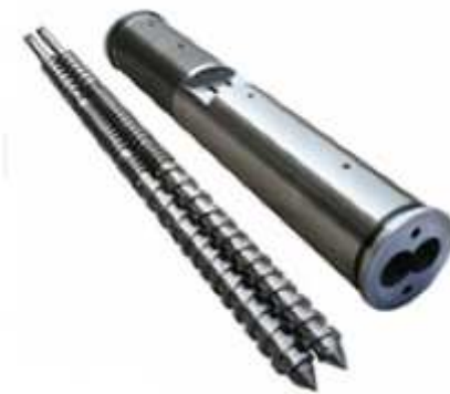
Obr. 8 Taviaca komora dvojšróbovéhoextrudéru [63]
