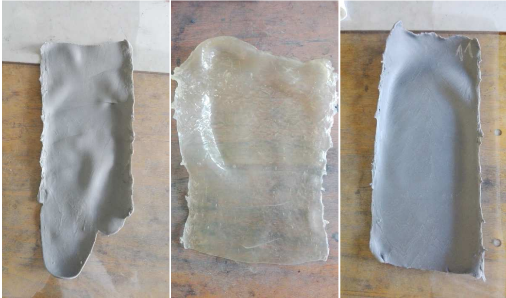
Obr. 15 Ukážky hotových fólií. Zľava: zmes 10, PVB-R, zmes 11
