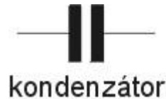
Obr.14. Schématická značka kondenzátoru
