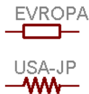
Obr.12. Schématické značky rezistoru
