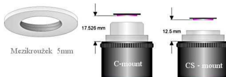
Obr. 19. Způsoby uchycení objektivů
