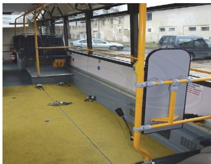
Obrázek 2 Zdvihací plošina a prostor pro umístění invalidního vozíku [41]
