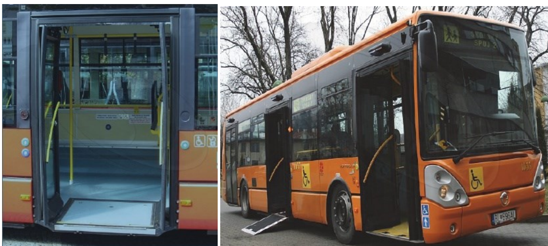
Obrázek 2 Zdvihací plošina a prostor pro umístění invalidního vozíku [41]
