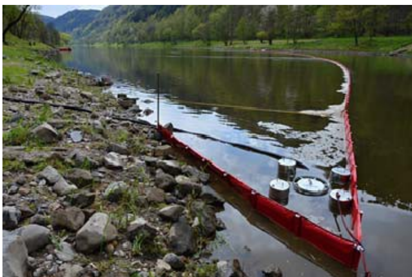
Obrázek 16 Norná stěna s kapsou a skimmerem [37]
