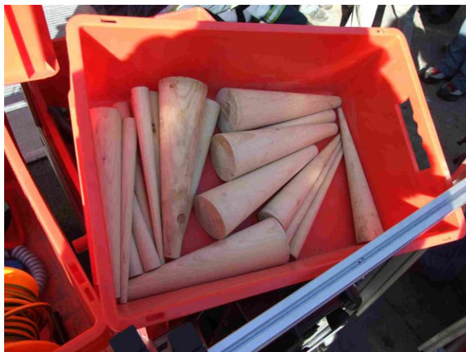
Obrázek 17 Klíny určené k utěsnění porušené nádoby [43]
