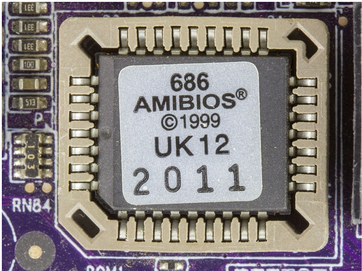
Obrázek 2 – Paměťový čip, na kterém je uložen BIOS [Zdroj: 19]
