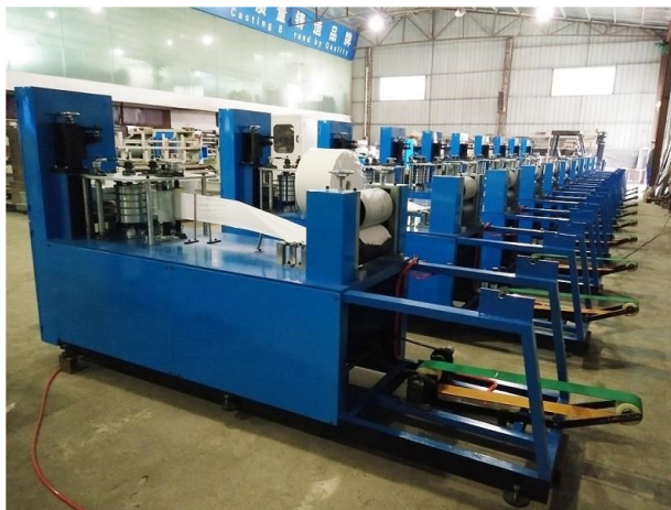
Obr. 7 – Ilustrační obrázek strojů na výrobu papírových ubrousků [44]
