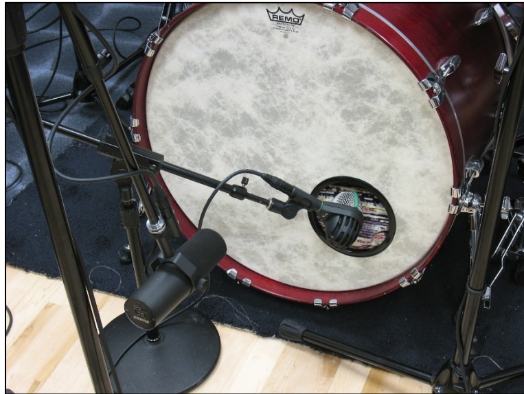
Obrázok 15. Snímanie veľkého bubna pomocou dvoch mikrofónov
