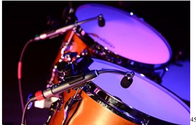
Obrázok 17. Kontaktné snímanie prechodov
