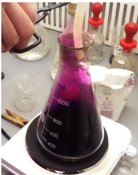
Obr. 13. Zviditeľňovanie daktyloskopických stôp pomocou jódových pár. [8]
