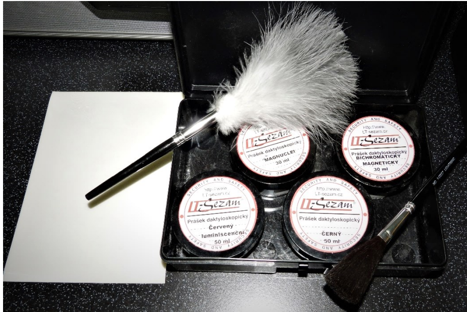
Obr. 10. Biela daktyloskopická fólia, sada daktyloskopických práškov, štetec z peria (vľavo) a z ťavej srsti (vpravo).
