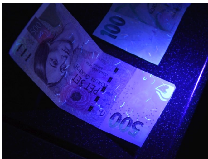
Obr. 14. Fotoluminiscencia bezpečnostných prvkov bankoviek pod UV žiarením.
