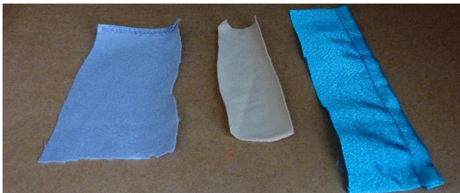
Obr. 39. Vybrané kusy tkaniny: polyester (vľavo), polyamid a elastan (v strede), satén (vpravo).
