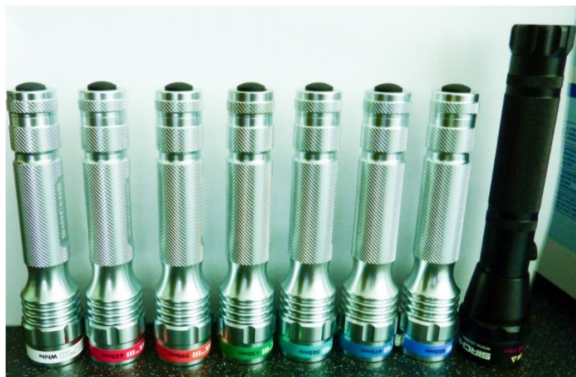
Obr. 34. Použitie LED svetlá s charakteristickou vlnovou dĺžkou.
